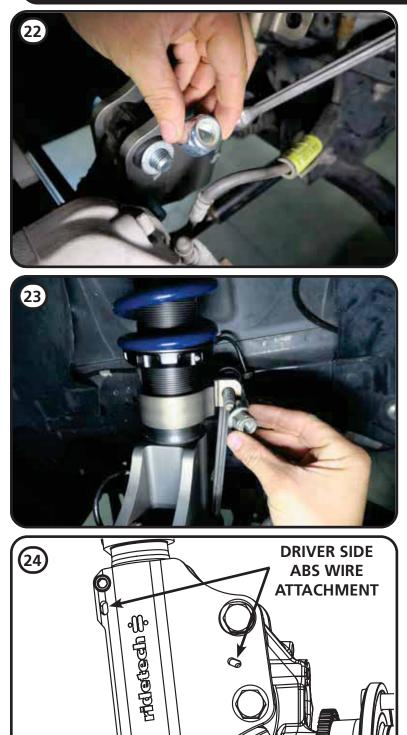
**22.** Install the OEM nut on the bolt.
